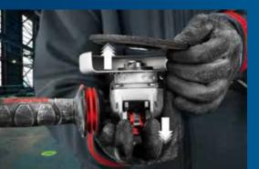
X-LOCK est un système révolutionnaire pour meuleuses angulaires signé Bosch Professional. Il permet le changement d'accessoires en un seul clic et en toute sécurité. Rapide, fiable, ne nécessitant aucun outil et compatible avec de nombreuses marques d'autres fabricants, il deviendra sans tarder la nouvelle norme du marché.
